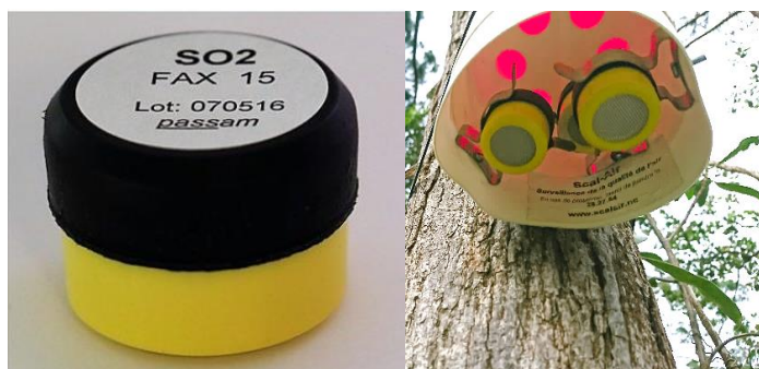
Figure 1: Dispositif de mesures passives du SO 2 par tubes Passam Ag
